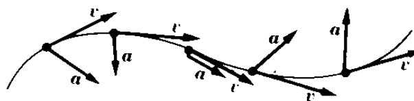
Fig. 5-12. Relación vectorial entre la velocidad y la aceleración en el movimiento curvilíneo.
